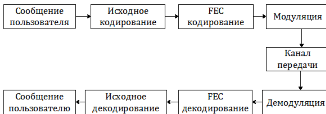
Рис.9.4. Блок-схема информационных потоков в системе цифровой связи
